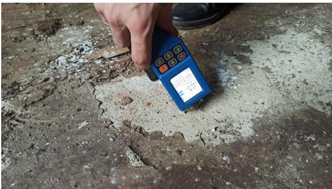
Рис. 37. Измерение прочности бетона полов
