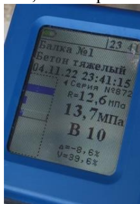
Рис. 13. Измерение прочности отмостки фундамента (увеличенное показание прибора)
