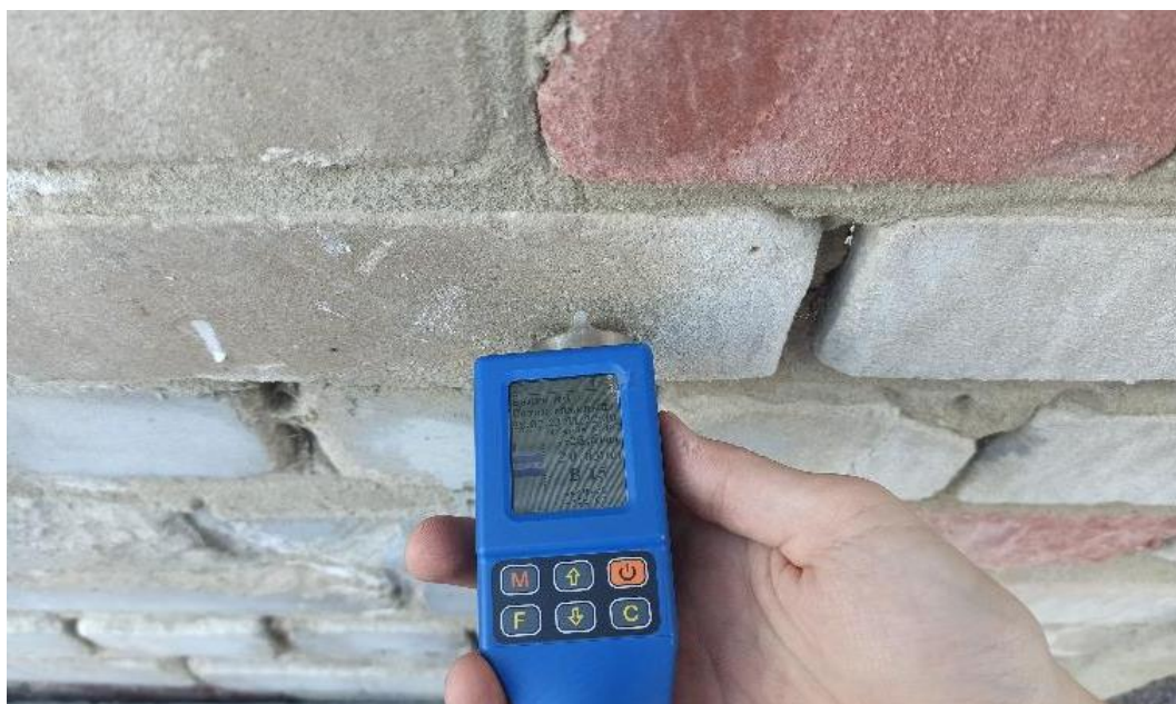
Рис. 26. Измерение прочности кирпича кладки стен неразрушающим способом (М100-М150)
